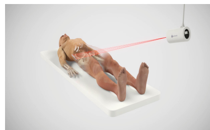
Ortoma Guide™ med ett IR-baserat enkamerasytem
